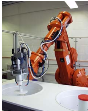
Roboter beim Polieren einer asphärischen Linse
